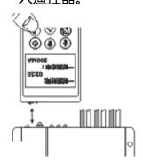
2、按住 MiniRC 的 A 键不放,同时按 RC-DER2 的读取键可以查看 MiniRC 参数。
